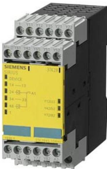
SIRIUS Sicherheitsschaltgerät mit Relais- und elektronischen Freigabekreisen (FK) DC 24 V, 45 mm Schraubanschluss FK unverzögert: 4 S FK verzögert: 0 MK: 1 überwachter Start Grundgerät maximal erreichbarer PL nach EN 13849-1: e maximal erreichbarer SIL nach IEC 61508: 3
