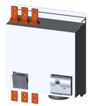
SIRIUS Sanftstarter Werte bei 460 V, 50 °C Standard: 1076 A, 950 hp Wurzel-3: 1864 A, 1700 hp AC 200-460 V, AC 115 V Federzugklemmen
