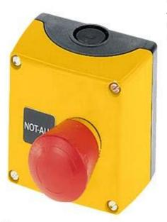
GEHAEUSE FUER BEFEHLSGERAETE, 22MM, RUND, GEHAEUSEMATERIAL METALL, GEHAEUSEOBERTEIL GELB, 1 BEFEHLSSTELLE, A=NOT-HALT-PILZDRUCKTASTER ROT, 40MM, DREHENTRIEGELT, 20E, FEDERZUGANSCHLUSS,, BODENBEFESTIGUNG, 2 LOSE SCHILDER, M12-STECKER (5-POLIG)
