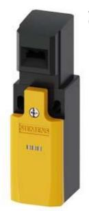
Sicherheits-Positionsschalter mit getrenntem Betätiger Kunststoffgehäuse, 31 mm Geräteanschluss 1x (M20x 1,5) Schleichschaltglieder 1S/1Ö 2x LEDs gelb/grün DC 24 V 5 Anfahrrichtungen der dazu passende getrennte Betätiger 3SE5000-0AV0./-0AW. muss separat bestellt werden
