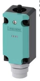
Basisschalter für Positionsschalter 3SE51 Metallgehäuse 40 mm nach DIN EN 50041 mit Stecker 6+PE nach EN 43651 mit 2 LED, gelb/grün DC 24 V 1S/1Ö Sprungkontakte ohne Antriebskopf Pin-Belegung: Pin1=21, Pin2=22 Pin3=14 und LED grün, Pin4=13 und LED gelb, Pin5=nicht angeschlossen, Pin6=Masse LED dazu passende Kabeldose 3SY3123
