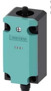
Basisschalter für Positionsschalter 3SE51 Metallgehäuse 40 mm nach DIN EN 50041 1S/1Ö Sprungkontakte mit M12-Stecker, 5-polig, fest mit 2 LED, gelb/grün, DC 24 V ohne Antriebskopf Pin-Belegung: Pin1=21, Pin2=22 Pin3=13 und LED grün, Pin4=14 und LED gelb, Pin5=Masse LED
