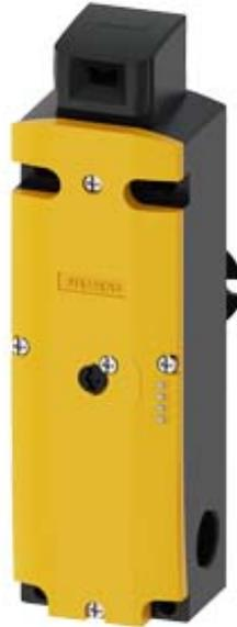
Sicherheits-Positionsschalter mit Zuhaltung Zuhaltekraft 1300 N 5 Anfahrrichtungen Federkraftverriegelt Fluchtentriegelung von hinten und Hilfsentriegelung vorne Magnetspannung AC 230 V Überwachung Betätiger 2Ö/1S Überwachung Magnet 2Ö/1S LED-Anzeige gelb/grün Lieferung ohne Betätiger. Betätiger 3SE5000-0AV0. bitte separat bestellen
