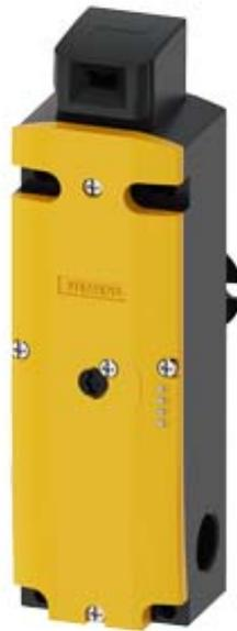
Sicherheits-Positionsschalter mit Zuhaltung Zuhaltekraft 1300 N 5 Anfahrrichtungen Federkraftverriegelt Notensperrung hinten und Hilfsentriegelung vorne Magnetspannung AC 115 V Überwachung Betätiger 2Ö/1S Überwachung Magnet 2Ö/1S LED-Anzeige gelb/grün Lieferung ohne Betätiger. Betätiger 3SE5000-0AV0. bitte separat bestellen
