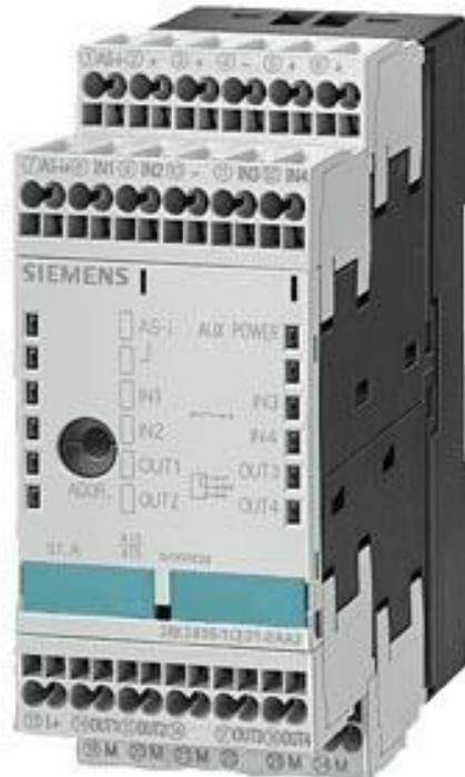
AS-i SlimLine Modul Auslaufprodukt !!! für weitere Infos wenden Sie sich bitte an unseren Vertrieb S45 digital, A/B-Slave 4DI/4DQ, IP20 4 x Eingang für 3-Leiter Sensor 4 x Ausgang, 2 A, DC 24 V maximal 4 A für alle Ausgänge Federzugklemmen Baubreite 45 mm
