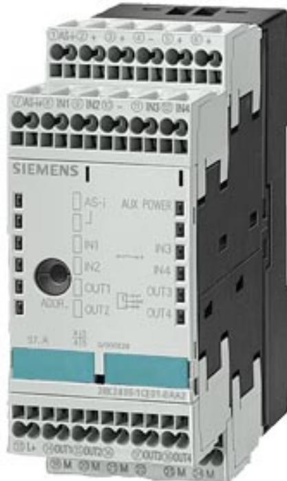
AS-i SlimLine Modul Auslaufprodukt !!! für weitere Infos wenden Sie sich bitte an unseren Vertrieb S45 digital, A/B-Slave 4DI/4DQ, IP20 4 x Eingang für 3-Leiter Sensor 4 x Ausgang, 2 A, DC 24 V maximal 4 A für alle Ausgänge Schraubklemmen Baubreite 45 mm
