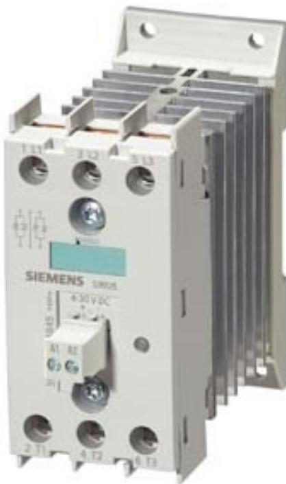
Halbleiterschütz 3-phäsig 3RF2 AC 51 / 10 A / 40 °C 48-600 V / 230 V AC 2-Phasengesteuert Schraubanschluss Sperrspannung 1200 V
