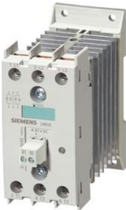
Halbleiterschütz 3-phasisch 3RF2 AC 51 / 10 A / 40 °C 48-600 V / DC 4-30 V 2-Phasengesteuert
