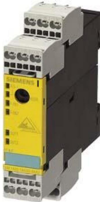
ASIsafe SlimLine Modul S22.5F Auslaufprodukt !!! für weitere Infos wenden Sie sich bitte an unseren Vertrieb digital safety, 2F-DI/2DQ, IP20 2 x Eingang für mechanische Sensoren 2 x Standard Ausgang DC 24 V Ausgangsversorgung aus DC 24 V Schraubklemmen Baubreite 22,5 mm
