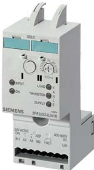
Heizstromüberwachung Strombereich 32 A / 40 °C 400-600 V / AC/DC 24 V für Halbleiterrelais / Schütz
