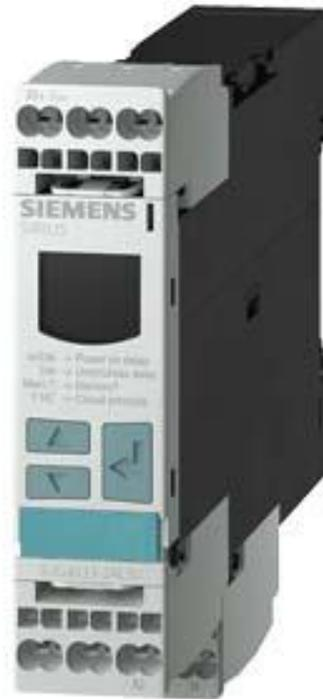
Digitales Überwachungsrelais Spannungsüberwachung, 22.5 mm von 17-275 V AC/DC Über- und Unterschreitung eigenversorgt DC und AC 50 bis 60 Hz Störspitzenverzögerung 0,1 bis 20 s Hysterese 0.1 bis 150 V 1 Wechsler mit oder ohne Fehlerspeicher Schraubanschluss Nachfolgeprodukt für 3UG3534, 3UG3535
