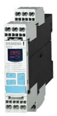
Digitales Überwachungsrelais Asymmetrie 0-20% zuschaltbare Phasenfolge Phasenausfall 3 x 160 bis 690 V AC 50 bis 60Hz Unterspannung 160-690 V Hysterese 1-20 V Ein- und Abschaltverzög. 0-20 s 2 Wechsler Federzugtechnik
