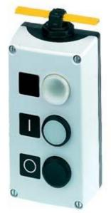
AS-Interface-Gehäuse für Befehlsgeräte, 22 mm, rund, Gehäusematerial Metall, Gehäuseoberteil grau, 3 Befehlsstellen, C=Drucktaster, schwarz, 1S, Schild: II, B=Drucktaster, schwarz, 1S, Schild: I, A=Drucktaster, rot, 1S, Schild: O, Kabeldurchführung oben
