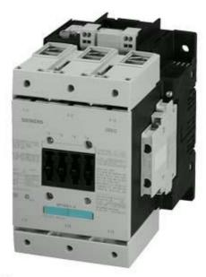
Schütz, AC - 3, 55 kW / 400 V, AC (50...60Hz) / DC-Betätigung UC 21 - 27, 3 V Hilfskontakte 2 NO + 2 NC 3-polig, Baugröße S6 mit Rahmenklemmen Antrieb: elektronisch mit SPS-Schnittstelle DC 24 V Federzuganschlusstechnik
