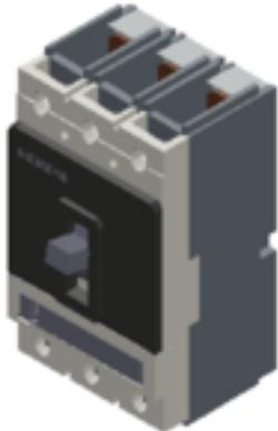
Leistungsschalter VL250N Standardschaltvermögen  $I_{cu}=55\text{kA}$ , 415V AC 3-polig, Anlagenschutz Überstromauslöser TM, LI  $I_{n}=200\text{A}$ , Bemessungsstrom  $I_{R}=160\ldots200\text{A}$ , Überlastschutz, II=1000...2000A, Kurzschlusschutz
