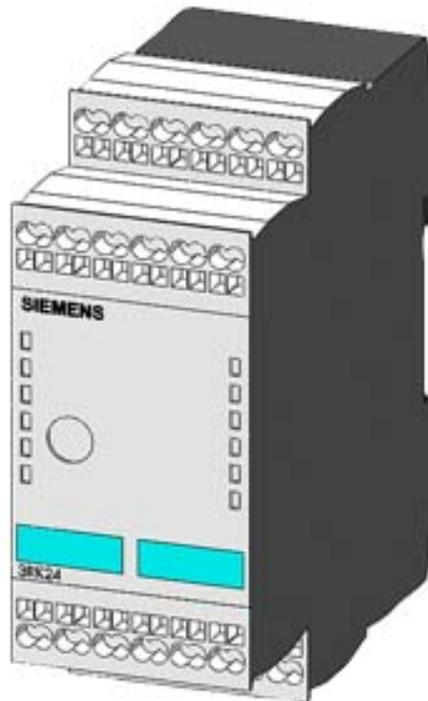
AS-i SlimLine Modul Auslaufprodukt !!! für weitere Infos wenden Sie sich bitte an unseren Vertrieb S45, digital 4DI/4DQ, IP20 4 x Eingang für 3-Leiter Sensor 4 x Ausgang, 2 A, DC 24 V maximal 4 A für alle Ausgänge Federzugklemmen Baubreite 45 mm
