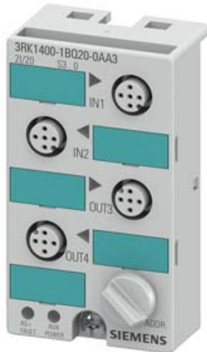
AS-i Kompaktmodul K45 digital 2DI/2DQ, IP67 2 x Eingang, maximal 200 mA 2 x Ausgang, 2 A DC 24 V maxima 3 A für alle Ausgänge 4 x M12-Buchse Montageplatte 3RK1901-2EA00 oder 3RK1901-2DA00 ist separat zu bestellen
