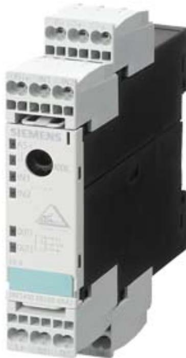
AS-i SlimLine Modul Auslaufprodukt !!! für weitere Infos wenden Sie sich bitte an unseren Vertrieb SC22.5 digital 2DI/2DQ, IP20 2 x Eingang für 3-Leiter Sensor 2 x Ausgang, 2 A, DC 24 V Federzugklemmen Baubreite 22,5 mm
