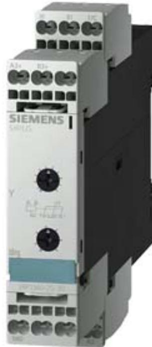
Zeitrelais, elektronisch Auslaufprodukt !!! für weitere Infos wenden Sie sich bitte an unseren Vertrieb mit Stern-Dreieck-Funktion 1...20 s, Nachlaufzeit 30-600 s 0,85 ...1,1 US AC/DC 24 V, AC 200...240 V bei AC 50/60 Hz Federzugklemme
