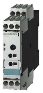
Zeitrelais, Multifunktion Auslaufprodukt !!! für weitere Infos wenden Sie sich bitte an unseren Vertrieb 2 Wechsler, 16 Funktionen 15 Zeitbereiche (0,05 s-100 h) AC/DC 24... 240 V bei AC 50/60 Hz mit LED, Schraubanschluss
