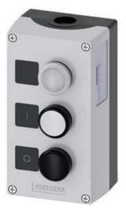
Gehäuse für Befehlsgeräte, 22 mm, rund, Gehäusematerial Kunststoff, Gehäuseoberteil grau, 3 Befehlsstellen Kunststoff, C=Leuchtmelder klar, Schild, LED 24 V, Schraubanschluss, B=Drucktaster weiß, Schild: I, 1S, Schraubanschluss, A=Drucktaster schwarz,Schild:O, 1Ö, Schraubanschluss, Bodenbefestigung, oben und unten je 1xM20
