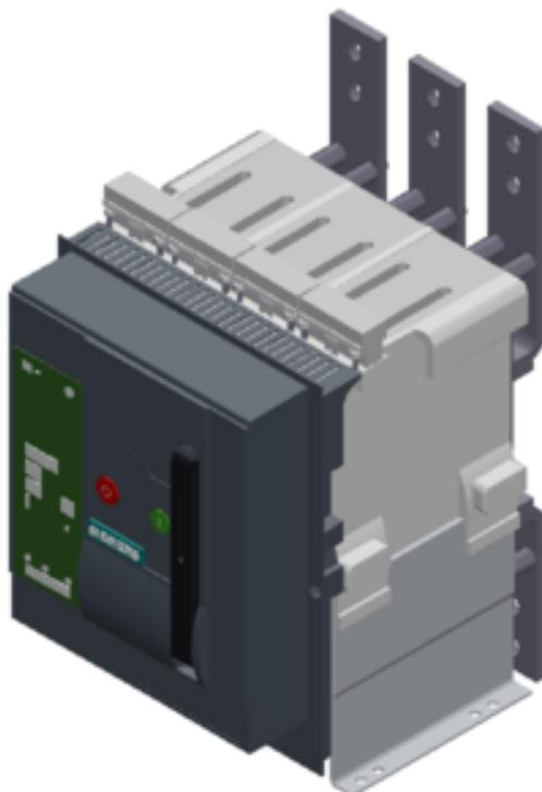
Festeinbau-Leistungsschalter approbiert nach UL 489 3-polig, Baugröße 1, In=1000A AC 50/60Hz, IEC: bis 690V, 65kA bei 440V UL: 600Y/347, 65kA bei 480V
