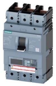
Leistungsschalter 3VA6 UL Frame 600 Schaltvermögenklasse H 65kA @ 480V 3-polig, Anlagenschutz ETU820, LI, In=600A Überlastschutz Ir=240A...600A Kurzschlussschutz Ii=1,5...10 x In ohne Anschluss
