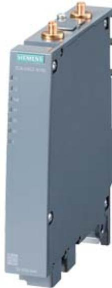
IWLAN Client, SCALANCE W734-1, RJ45, 1 Radio, 2 R-SMA-Antennenanschluss, iFeatures Support via KEY-PLUG, IEEE 802.11a/b/g/h/n, 2,4/5GHz, Brutto-Data-Rate 300 Mbit/s, 2x RJ45 max. 100 Mbit/s, PoE integrierter 2-Port-Switch, Redundant DC 24 V, Klemmblock, IP30, -20... 60°C, Plug-Schacht WPA2/802.11i/e, Länderzulassungen beachten! CERT ID: MSN-W1-RJ-E2, Lieferumfang: Handbücher auf CD-ROM, deutsch/englisch, 1x Klemmblock; z. Betrieb außerhalb USA/Israel
