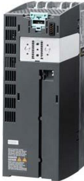
SIPLUS G120 PM 240-2 FSB 7.5kW Power Module PM 240-2 ungefilt. -20...+50°C mit conformal coating based on 6SL3210-1PE21-8UL0 . mit integriertem Brems-Chopper 3AC380-480V+10/-10% 47-63Hz Leistung hohe Überlast: 5,5kW bei 200% 3S, 150% 57S, 100% 240S Leistung geringe Überlast: 7,5kW bei 150% 3S, 110% 57S, 100% 240S 291x 100x 165 (HxBxT), FSB Schutzart IP20 ohne Control Unit und Bedieneinheit freigegeben ab Firmware- Version V4.6
