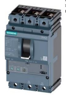
Leistungsschalter 3VA2 IEC Frame 160 Schaltvermögenklasse H Icu=85kA @ 415V 3-polig, Anlagenschutz ETU320, LI, In=160A Überlastschutz Ir=63A...160A Kurzschlussschutz Ii=1,5...10 x In Schraubenflachanschluss Unterspannungsauslöser (UVR) 24V DC 2 Hilfsschalter HQ
