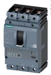
Leistungsschalter 3VA2 IEC Frame 160 Schaltvermögenklasse C Icu=110kA @ 415V 3-polig, Motorschutz ETU350M, LSI, In=63A Überlastschutz Ir=25A...63A Kurzschlussschutz Isd=3...15 x Ir, Ii=15 x In Schraubenflachanschluss Unterspannungsauslöser (UVR) 24V DC 2 Hilfsschalter HQ 1 Ausgelöst-Meldeschalter HQ 1 Schutzauslöser-Meldeschalter
