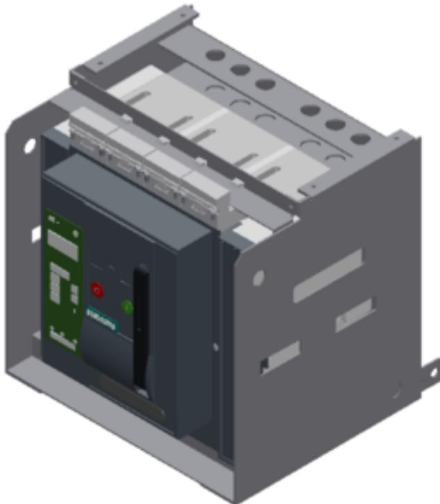
Einschub-Leistungsschalter mit Einschubrahmen 3-polig, Baugröße 2, IEC In=3200A bis 690V, AC 50/60Hz
