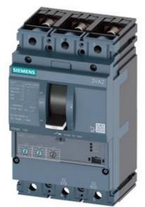
Leistungsschalter 3VA2 IEC Frame 100 Schaltvermögenklasse M Icu=55kA @ 415V 3-polig, Anlagenschutz ETU320, LI, In=63A Überlastschutz Ir=25A...63A Kurzschlussschutz Ii=1,5...12 x In Schraubenflachanschluss 2 Hilfsschalter HP 1 Ausgelöst-Meldeschalter HP
