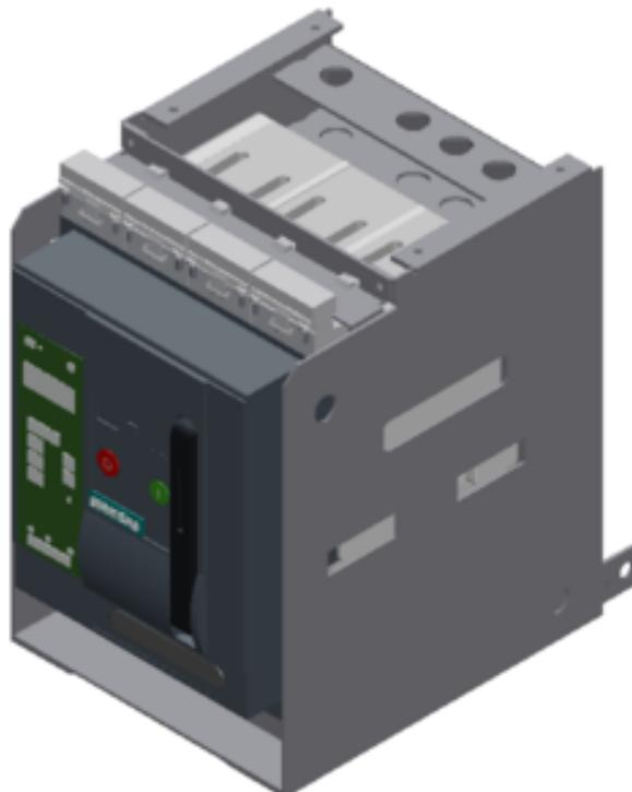
Einschub-Leistungsschalter mit Einschubrahmen 3-polig, Baugröße 1, IEC In=1250A bis 690V, AC 50/60Hz
