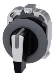
Knebelschalter, beleuchtbar, 30 mm, rund, Metall, matt, weiß, Knebel, lang, Frontring für flachen Einbau, 3 Schaltstellungen I>O<II, tastend, Schaltwinkel 2x45°, 10:30h/12h/13:30h, mit Laserbeschriftung, Groß- und Kleinschreibweise, Wortanfang immer groß
