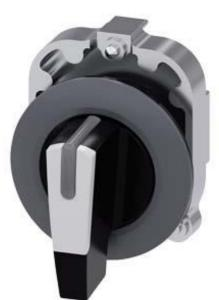
Knebelschalter, beleuchtbar, 30 mm, rund, Metall, matt, weiß, Knebel, lang, Frontring für flachen Einbau, 3 Schaltstellungen I>O<II, tastend, Schaltwinkel 2x45°, 10:30h/12h/13:30h, mit Laserbeschriftung, Aufschrift oder Bildzeichen kundenspezifische Auswahl mit SIRIUS-Act Konfigurator (CIN)
