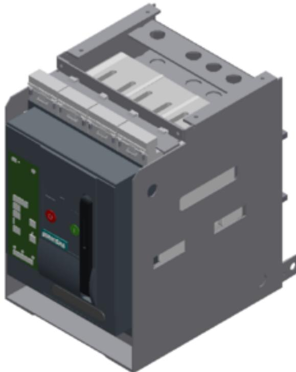
Einschub-Leistungsschalter mit Einschubrahmen 3-polig, Baugröße 1, IEC In=800A bis 690V, AC 50/60Hz
