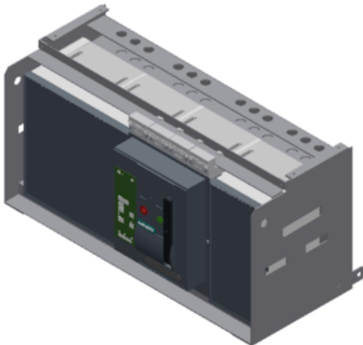
Einschub-Leistungsschalter mit Einschubrahmen 4-polig, Baugröße 3, IEC In=4000A bis 690V, AC 50/60Hz
