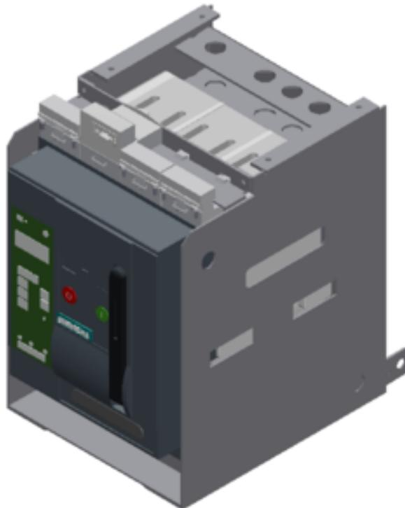
Einschub-Leistungsschalter mit Einschubrahmen 3-polig, Baugröße 1, IEC In=1600A bis 690V, AC 50/60Hz
