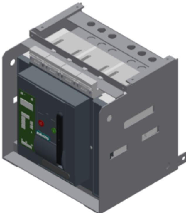
Einschub-Leistungsschalter mit Einschubrahmen 3-polig, Baugröße 2, IEC In=2000A bis 690V, AC 50/60Hz
