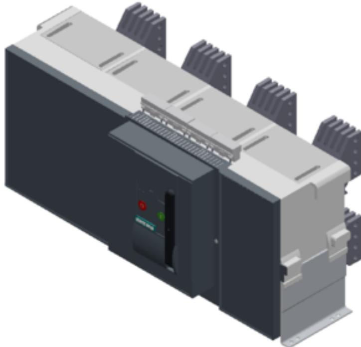
Festeinbau-Leistungstrennschalter 4-polig, Baugröße 3, IEC In=5000A bis 690V, AC 50/60Hz Icu=100kA bei 500V Anschluss rückseitig vertikal
