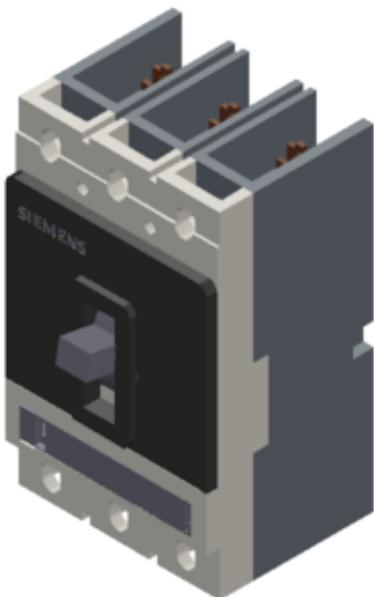
Leistungsschalter VL150 UL Typ DG (CAT NO. HDP3H150) non-interchangeable frame, mit Approbation Circuit-Breaker nach UL 489 hohes Schaltvermögen 3-polig; NEMA Rating 65KA@480V und 18KA@600/347V (Motor Starter Protector) Überstromauslöser magnetisch TU=40°C In=150A, Bemessungsstrom II=1250..2500A Kurzschlusschutz Starterkombination ohne Anschlusszubehör
