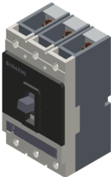
Leistungsschalter VL160N Standardschaltvermögen  $I_{cu}=55\text{kA}$ , 415V AC 3-polig, Motor-/Generatorschutz Überstromauslöser ETU10M,  $I_{n}=63\text{A}$ , Bemessungsstrom  $IR=25\ldots63\text{A}$ , Überlastschutz,  $II=1,25$  bis  $11 \times IN$ , Kurzschlusschutz mit Schraubanschluss
