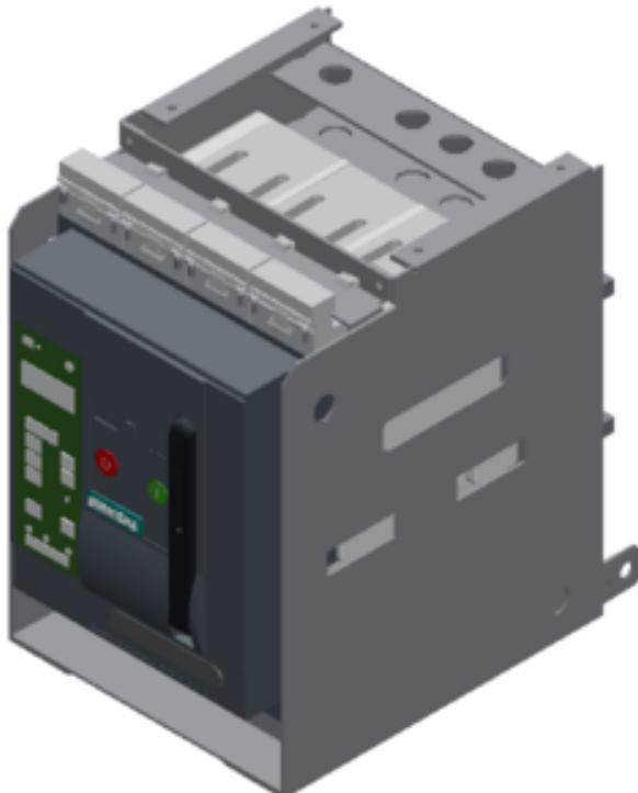
Einschub-Leistungsschalter mit Einschubrahmen 3-polig, Baugröße 1, IEC In=1600A bis 690V, AC 50/60Hz
