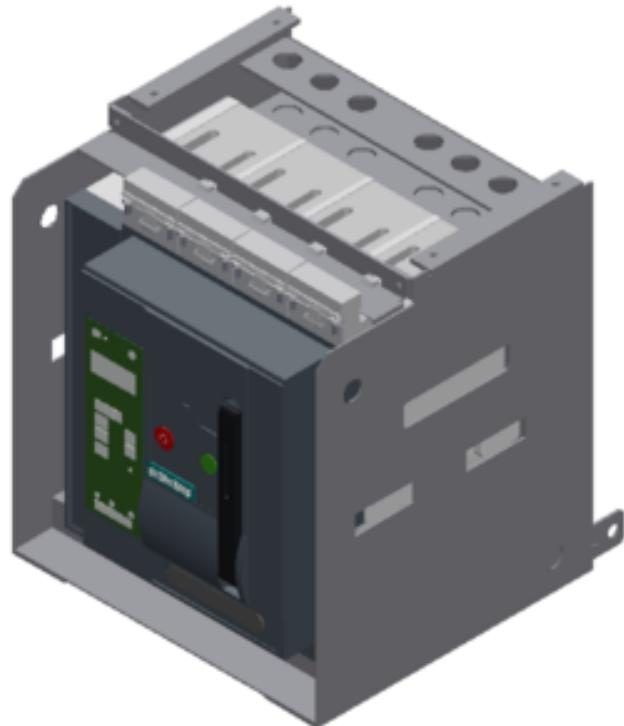
Einschub-Leistungsschalter mit Einschubrahmen 4-polig, Baugröße 1, IEC In=1250A bis 690V, AC 50/60Hz
