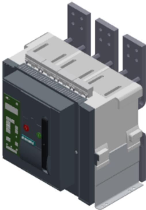
Festeinbau-Leistungsschalter approbiert nach UL 489 3-polig, Baugröße 2, In=3000A AC 50/60Hz, IEC: bis 690V, 100kA bei 440V UL: bis 600V, 100kA bei 480V
