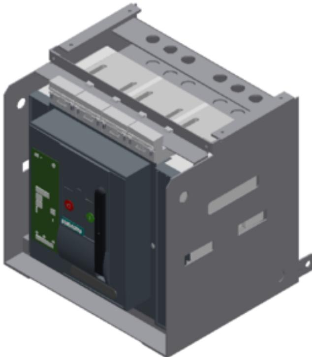
Einschub-Leistungsschalter approbiert nach UL 489 mit Einschubrahmen 3-polig, Baugröße 2, In=3000A AC 50/60Hz, IEC: bis 690V, 100kA bei 440V UL: bis 600V, 100kA bei 480V Anschluss rückseitig horizontal
