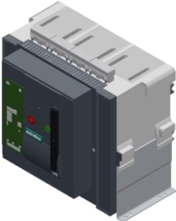
Festeinbau-Leistungsschalter approbiert nach UL 489 3-polig, Baugröße 2, In=3000A AC 50/60Hz, IEC: bis 690V, 100kA bei 440V UL: bis 600V, 100kA bei 480V
