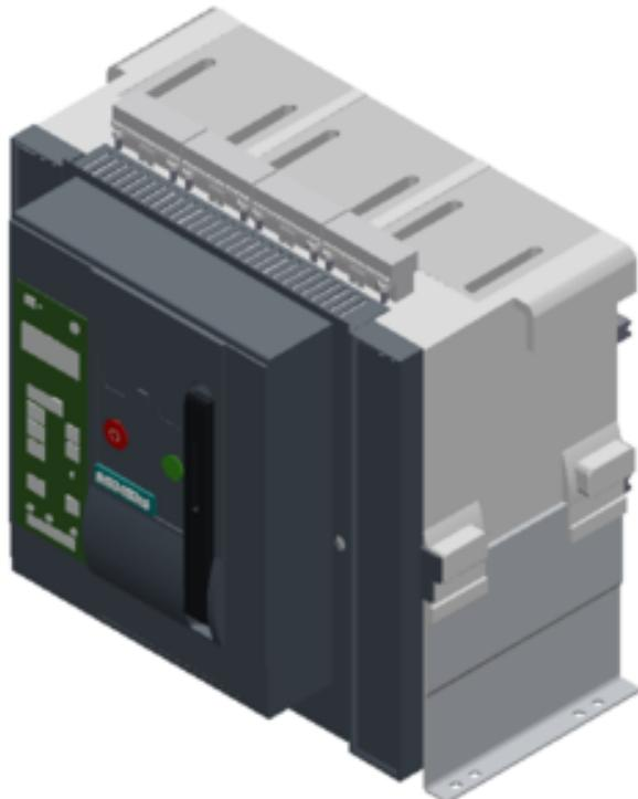
Festeinbau-Leistungsschalter approbiert nach UL 489 3-polig, Baugröße 2, In=2500A AC 50/60Hz, IEC: bis 690V, 100kA bei 440V UL: bis 600V, 100kA bei 480V
