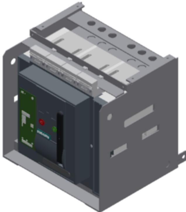
Einschub-Leistungsschalter approbiert nach UL 489 mit Einschubrahmen 3-polig, Baugröße 2, In=2500A AC 50/60Hz, IEC: bis 690V, 100kA bei 440V UL: bis 600V, 100kA bei 480V Anschluss rückseitig horizontal
